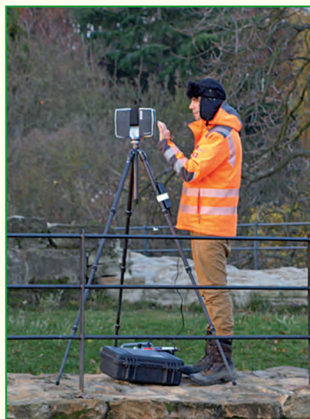
Ein unauffälliges Gerät im Einsatz – der 3D-Laserscanner und S. Tegge bei der Aufnahme der Wachtenburg im Nov. 2016 (Foto H. Grönwald).
