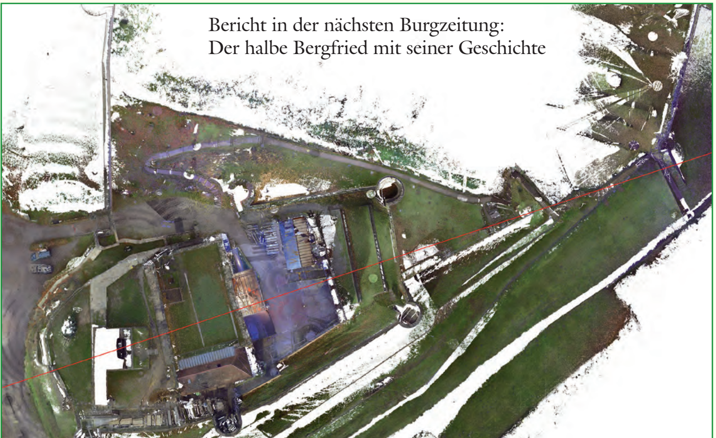
Abb. 4: Ungewohnte Optik - Ausschnitt der Aufsicht auf den Burgberg im aus der im 3D-Laserscan erfassten Punktwolke exportierten Orthofoto. Die rote Achse zeichnet den Verlauf eines Längsschnittes durch die Burg nach (Scan S. Tegge, H. Grönwald).
